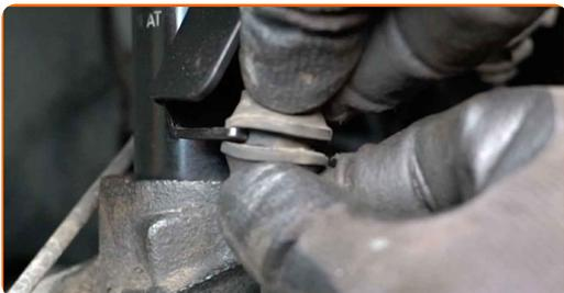
**69** Schrauben Sie die unteren Befestigungen des Federbeins fest. Verwenden Sie Stecknuss Nr. 15. Verwenden Sie einen Drehmomentschlüssel. Ziehen Sie ihn mit 110 Nm Drehmoment fest.
