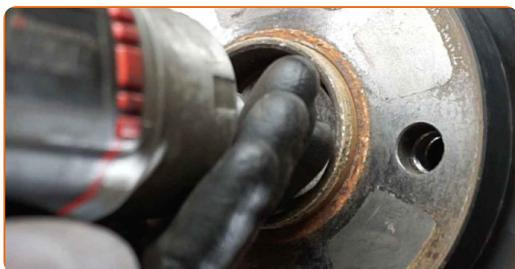
**22** Entfernen Sie die Befestigungsschraube.
