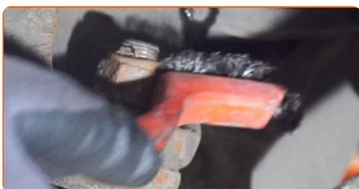
**24** Schrauben Sie die Befestigung ab, die das Traggelenk mit dem Achsschenkel verbindet. Verwenden Sie Ringgabelschlüssel Nr. 21.
