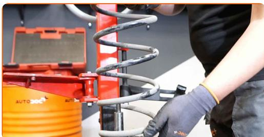
**39** Entfernen Sie die Staubmanschette.
