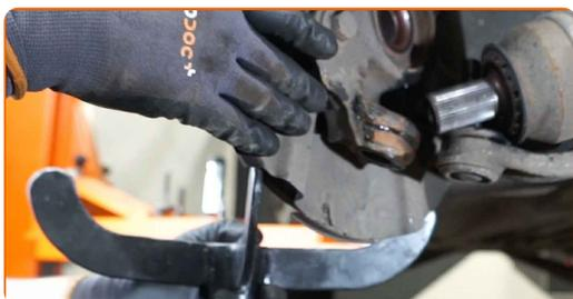
**28** Lösen Sie das untere Befestigungselement, dass das Federbein mit dem Achsschenkel verbindet. Verwenden Sie eine spezielle Schraubnuss, um den Stoßdämpfer zu entfernen.
