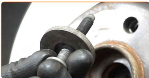
**23** Reinigen Sie das Verbindungselement, welches das Kugelgelenk mit dem Achsschenkel verbindet. Benutzen Sie eine Drahtbürste. Benutzen Sie WD-40-Spray.
