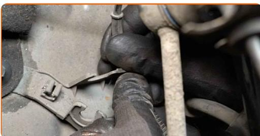
**68** Befestigen Sie den Bremsschlauch am Federbein.
