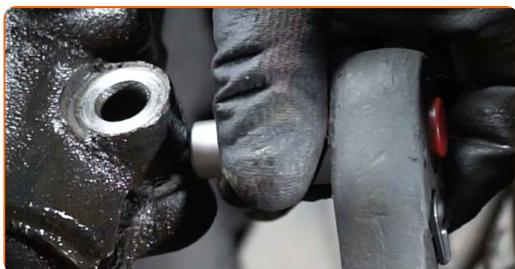
**29** Lösen Sie den Achsschenkel vom Federbein. Verwenden Sie einen Gummi-Hammer.
