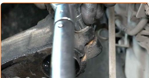
**70** Ziehen Sie das Befestigungselement fest, das das Traggelenk mit dem Achsschenkel verbindet. Verwenden Sie Ring-Gabelschlüssel Nr. 21. Verwenden Sie einen Drehmomentschlüssel. Ziehen Sie ihn mit 110 Nm Drehmoment fest.
