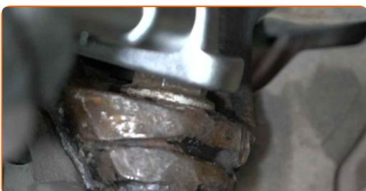
**71** Ziehen Sie das Befestigungselement an, das die Druckstange mit dem Federbein verbindet. Verwenden Sie Stecknuss Nr. 15. Verwenden Sie einen Drehmomentschlüssel. Ziehen Sie ihn mit 55 Nm Drehmoment fest.
