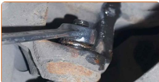
**25** Trennen Sie das Traggelenk vom Achsschenkel. Verwenden Sie einen Kugelgelenkabzieher. Benutzen Sie ein Brecheisen.
