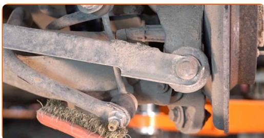
7 Drehen Sie die Befestigungen heraus, die die Druckstange mit dem Stabilisator verbinden. Verwenden Sie Stecknuss Nr. 18. Verwenden Sie einen Ratschenschlüssel.
