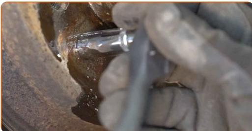
**18** Entfernen Sie die Bremsscheibe.
