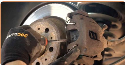
**11** Entfernen Sie den Bremssattel.
