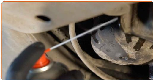
**11** Schrauben Sie den Ölfilter ab. Verwenden Sie Steckschlüssel 86/14-F.
