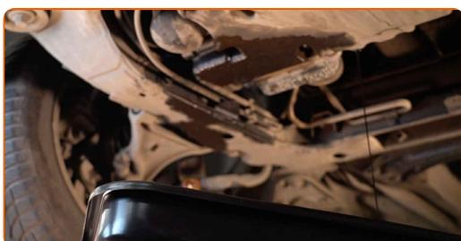
**10** Reinigen Sie den Deckel des Ölfilter-Gehäuses. Verwenden Sie Allzweckreinigungsspray.
