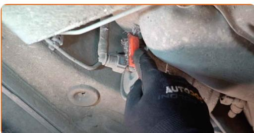
**6** Reinigen Sie die Kraftstoff-Filterhalterung. Benutzen Sie eine Drahtbürste. Benutzen Sie WD-40-Spray.
