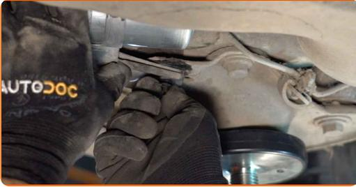
**16** Schrauben Sie die Befestigungsbolzen der Treibstofffilterhalterung an. Verwenden Sie Stecknuss Nr. 12. Verwenden Sie einen Ratschenschlüssel.
