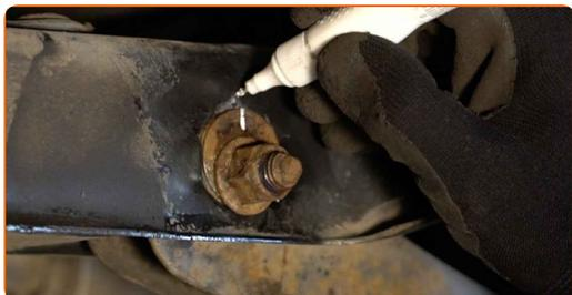
**11** Drehen Sie das Befestigungselement auf, das den Querlenker mit dem hinteren Hilfsrahmen verbindet. Verwenden Sie Ring-Gabelschlüssel Nr. 18. Verwenden Sie Ring-Gabelschlüssel Nr. 19. Verwenden Sie Stecknuss Nr. 18. Verwenden Sie einen Ratschenschlüssel.
