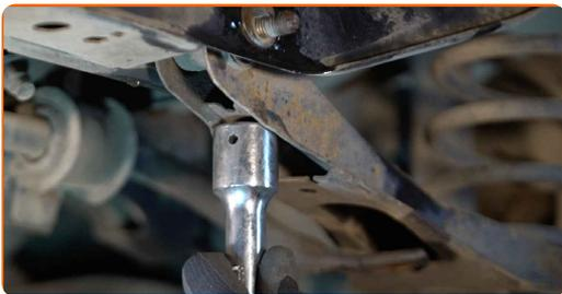
**13** Entfernen Sie die Befestigungsschraube. Verwenden Sie einen Splintentreiber. Benutzen Sie einen Hammer. Benutzen Sie ein Brecheisen.
