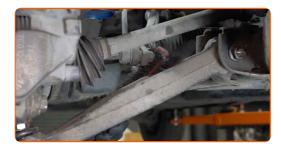
Schrauben Sie das Befestigungselement heraus, das die Druckstange mit dem Stabilisator verbindet. Verwenden Sie Stecknuss Nr. 18. Verwenden Sie einen Ratschenschlüssel.
