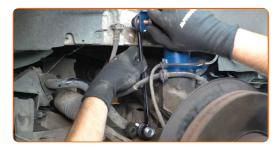
Ziehen Sie das Befestigungselement an, das die Druckstange mit dem Stabilisator verbindet. Verwenden Sie Stecknuss Nr. 19. Verwenden Sie einen Drehmomentschlüssel. Ziehen Sie ihn mit 60 Nm Drehmoment fest.+45°
