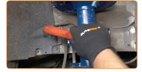
Schrauben Sie das Befestigungselement heraus, das die Druckstange mit dem Federbein verbindet. Verwenden Sie Stecknuss Nr. 18. Verwenden Sie einen Ratschenschlüssel.
