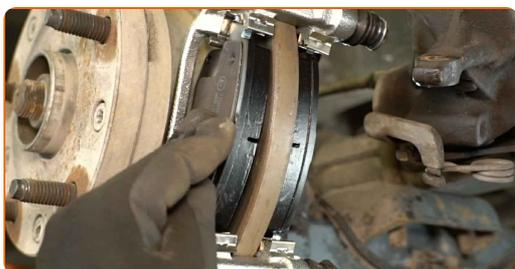
**26** Bringen Sie den Bremsbelagfühler am inneren Bremsbelag an.
