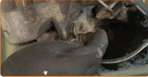
**12** Entfernen Sie den Bremssattel.
