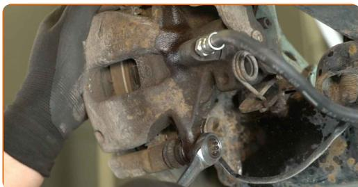
**11** Entfernen Sie die Befestigungsschrauben.
