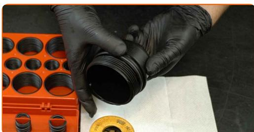
**18** Schmieren Sie den neuen Dichtring mit etwas frischem Öl.
