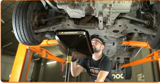
**7** Reinigen Sie den Bereich der Ölwanne um die Ölablassschraube herum. Benutzen Sie eine Drahtbürste. Verwenden Sie ein Allzweck-Reinigungsspray.
