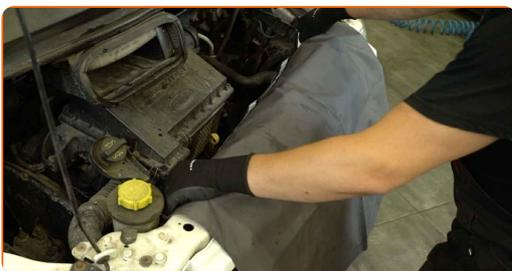
**3** Schrauben Sie den Öleinfülldeckel ab.
