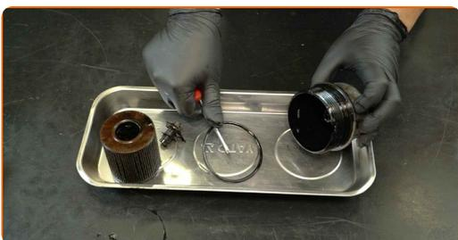
**13** Entfernen Sie den Dichtring von der Ablassschraube. Verwenden Sie einen Schlitzschraubendreher.
