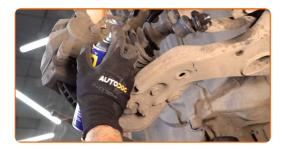
Lösen Sie die Befestigung der Sattelhalterung. Verwenden Sie Stecknuss Nr. 17. Verwenden Sie einen Ratschenschlüssel.
