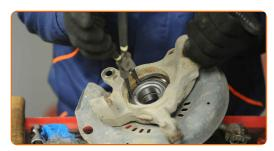
Drücken Sie die Radnabe in den Lagerinnenring. Verwenden Sie einen Druckstücksatz mit Ein-/Auspresswerkzeug.
