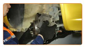
Befestigen Sie die Bremssattelhalterung. Verwenden Sie Stecknuss Nr. 17. Verwenden Sie einen Drehmomentschlüssel. Ziehen Sie ihn mit 88 Nm Drehmoment fest.
