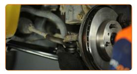
Ziehen Sie die Befestigungsmutter an, die den Spurstangenkopf mit dem Achsschenkel verbindet. Verwenden Sie Ring-Gabelschlüssel Nr. 17. Verwenden Sie einen Drehmomentschlüssel. Ziehen Sie ihn mit 49 Nm Drehmoment fest.
