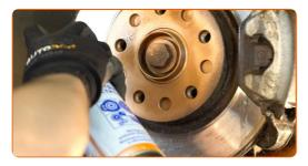
Die Bremsscheibenoberfläche reinigen. Benutzen Sie einen Bremsenreiniger.
