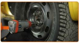
Senken Sie das Auto und ziehen Sie die Radschrauben über Kreuz an. Verwenden Sie eine Schlagnuss für Felgen # 21. Verwenden Sie einen Drehmomentschlüssel. Ziehen Sie ihn mit 103 Nm Drehmoment fest.
