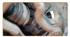
Die Antriebswellenmutter festziehen. Verwenden Sie Stecknuss Nr. 30. Verwenden Sie ein Windeisen. Verwenden Sie einen Drehmomentschlüssel. Ziehen Sie ihn mit 216 Nm Drehmoment fest.
