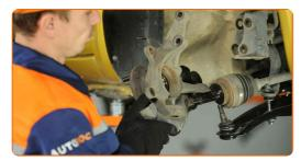
Drücken Sie die Radnabe aus dem Kegelrollenlager. Verwenden Sie einen Druckstücksatz mit Ein-/Auspresswerkzeug. Benutzen Sie einen Hammer.
