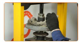
Installieren Sie den Achsschenkel mit einer Nabe.
