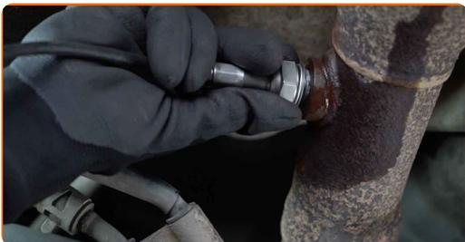
**10** Ziehen Sie die Befestigung der Lambdasonde fest. Verwenden Sie Ring-Gabelschlüssel Nr. 22. Verwenden Sie einen Drehmomentschlüssel. Ziehen Sie ihn mit 41 Nm Drehmoment fest.
