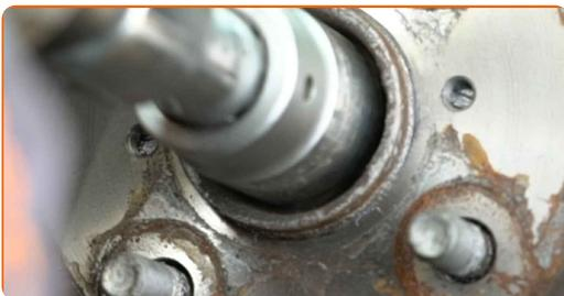
**18** Reinigen Sie das Verbindungselement, welches das Kugelgelenk mit dem Achsschenkel verbindet. Benutzen Sie eine Drahtbürste. Benutzen Sie WD-40-Spray.
