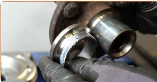
**41** Drücken Sie das Radnabenlager heraus. Verwenden Sie einen Druckstücksatz mit Ein-/Auspresswerkzeug.
