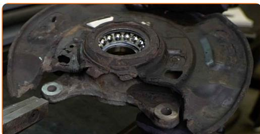
**38** Reinigen Sie den Sicherungsring des Radnabenlagers. Benutzen Sie eine Drahtbürste. Benutzen Sie WD-40-Spray.
