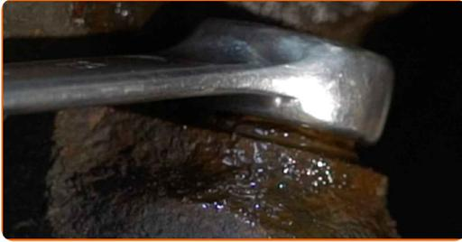
**21** Entfernen Sie die Befestigungsmutter.
