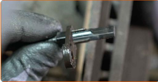
**17** Lösen Sie das Befestigungselement, welches die Antriebswelle mit der Radnabe verbindet. Verwenden Sie die 12-Kant-Stecknuss Nr. 30. Verwenden Sie einen Ratschenschlüssel.
