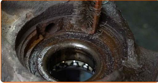
**39** Entfernen Sie den Sicherungsring am Radnabenlager. Verwenden Sie eine Sicherungsringzange.
