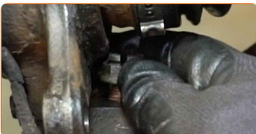
**54** Schrauben Sie das Befestigungselement ein, das das Federbein mit dem Achsschenkel verbindet. Verwenden Sie Ring-Gabelschlüssel Nr. 19. Verwenden Sie Stecknuss Nr. 19. Verwenden Sie einen Ratschenschlüssel.
