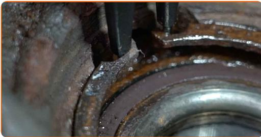
**40** Demontieren Sie den Lagerinnenring, der sich noch auf der Nabe befindet. Verwenden Sie einen Druckstücksatz mit Ein-/Auspresswerkzeug. Verwenden Sie ein ein Trennmesser für Lager.
