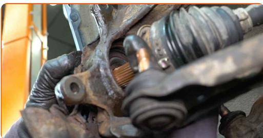
**52** Verbinden Sie das Kugelgelenk mit dem Achsschenkel.
