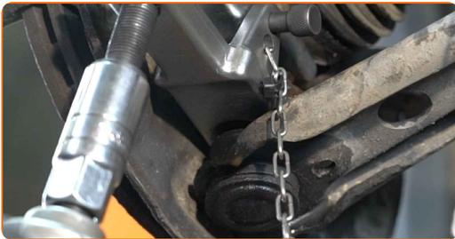
**23** Die Befestigungselemente der Bremssattelhalterung reinigen. Benutzen Sie eine Drahtbürste. Benutzen Sie WD-40-Spray.
