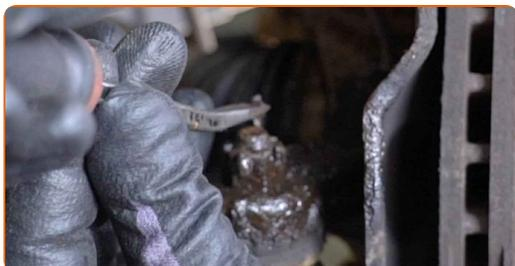
**11** Lösen Sie das Ende der Befestigungsmutter an dem Achsschenkel. Verwenden Sie Stecknuss Nr. 17. Verwenden Sie einen Ratschenschlüssel.
