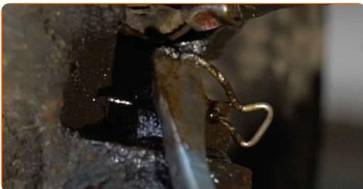
**20** Schrauben Sie die Kugelgelenkbefestigung vom Achsschenkel ab. Verwenden Sie Ring-Gabelschlüssel Nr. 19.
