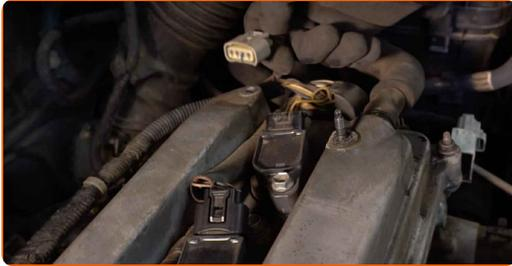
**6** Schrauben Sie die Zündspulenklammer ab. Verwenden Sie Stecknuss Nr. 10.
