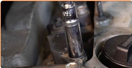
**7** Entfernen Sie die Befestigungsschrauben.
