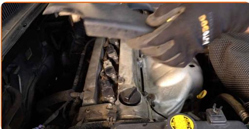
**5** Lösen Sie die Steckverbindung von den Zündspulen.
