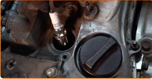
**14** Schrauben Sie die neuen Zündkerzen an und ziehen Sie diese fest. Verwenden Sie die Zündkerzennuss # 16. Verwenden Sie einen Drehmomentschlüssel. Ziehen Sie ihn mit 25 Nm Drehmoment fest.
