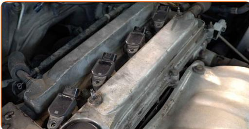
**8** Entnehmen Sie die Zündspule aus der Vertiefung für die Zündkerze.
