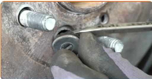
**21** Lösen Sie den Bremskolbenrücksteller. Verwenden Sie einen flachen Schraubendreher.
