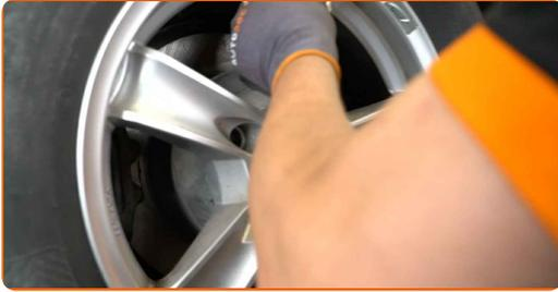
**57** Bringen Sie den Sicherungsring am Radnabenlager an.
