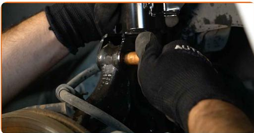
**44** Schrauben Sie das Befestigungselement ein, das das Federbein mit dem Achsschenkel verbindet. Verwenden Sie Ring-Gabelschlüssel Nr. 22. Verwenden Sie Stecknuss Nr. 22.
