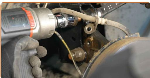
**45** Ziehen Sie die unteren Befestigungen an, die das Federbein mit dem Achsschenkel verbinden. Verwenden Sie Stecknuss Nr. 22. Verwenden Sie einen Drehmomentschlüssel. Ziehen Sie ihn mit 240 Nm Drehmoment fest.
