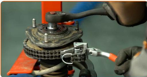
**26** Entfernen Sie die Stoßdämpferhalterung, die Manschette und den Stoßstopp. Benutzen Sie ein Brecheisen.
