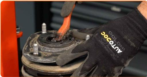
**25** Entfernen Sie die Stangenmutter des Federkolben. Verwenden Sie einen Kettenschlüssel. Verwenden Sie Stecknuss Nr. 21. Verwenden Sie einen Ratschenschlüssel.
