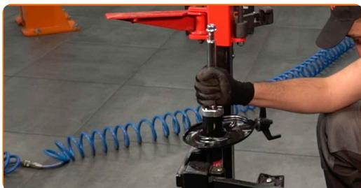
**31** Installieren Sie die Feder am Stoßdämpfer.
