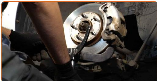
**17** Entfernen Sie die Befestigungsschrauben.
