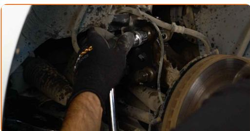
**16** Stützen Sie die Achsschenkel auf. Benutzen Sie einen hydraulischen Getriebeheber.
