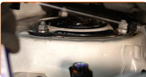
**4** Lösen Sie die obere Befestigung des Domlagers. Verwenden Sie Ring-Gabelschlüssel Nr. 14.
