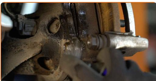
**14** Lösen Sie die Befestigung der Sattelhalterung. Verwenden Sie Stecknuss Nr. 14. Verwenden Sie ein Windeisen. Verwenden Sie einen Ratschenschlüssel.
