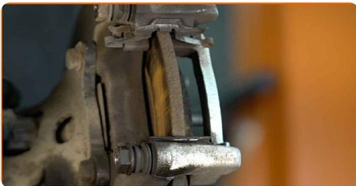
**13** Die Befestigungselemente der Bremssattelhalterung reinigen. Benutzen Sie eine Drahtbürste. Benutzen Sie WD-40-Spray.
