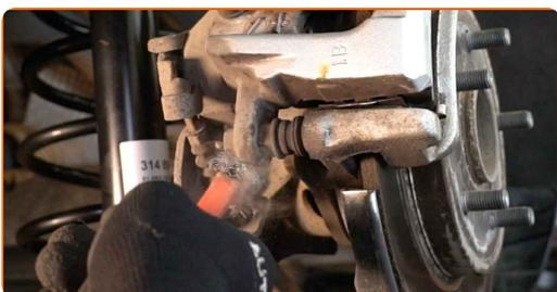
**8** Entfernen Sie das Handbremsseil aus dessen Befestigung am Bremssattel. Verwenden Sie eine Wasserpumpenzange.
