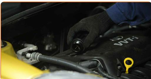
**20** Befestigen Sie den Deckel des Öleinfüllstutzens.
