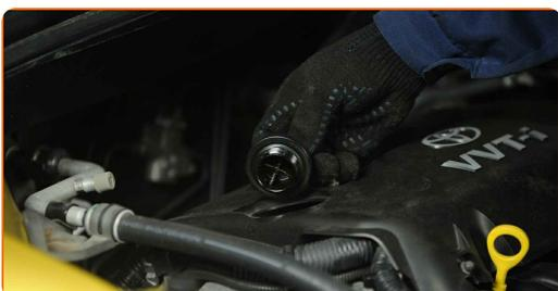
**15** Entfernen Sie die Öleinfüllschraube.
