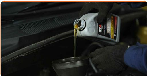
Austausch: Motoröl und Ölfilter – TOYOTA COROLLA Coupe (KE). Tipp von AUTODOC-Experten:
