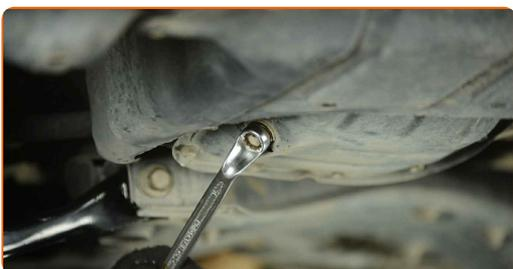
**11** Reinigen Sie den Bereich um die Ablassöffnung der Ölwanne. Verwenden Sie Allzweckreinigungsspray.
