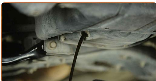
Austausch: Motoröl und Ölfilter – TOYOTA COROLLA Coupe (KE). Tipp von AUTODOC:
