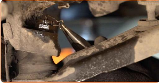
19 Schrauben Sie die Kugelgelenkbefestigung vom Achsschenkel ab. Verwenden Sie Ring-Gabelschlüssel Nr. 19.
