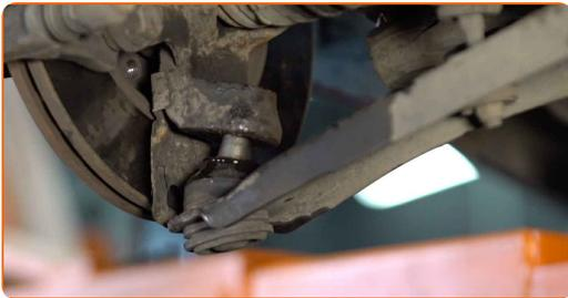
**54** Schrauben Sie die Befestigungen des Kugelgelenks ein. Verwenden Sie Ring-Gabelschlüssel Nr. 19.
