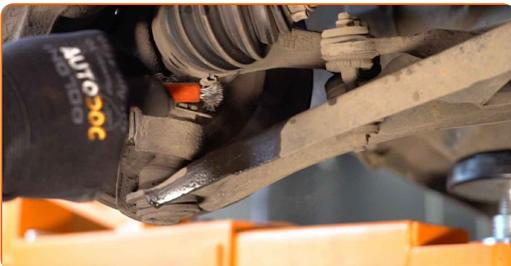
18 Entfernen Sie den Splint. Verwenden Sie eine Rundzange.
