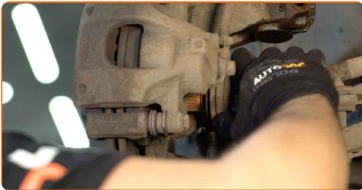
**53** Verbinden Sie den Unterarm mit dem Achsschenkel. Benutzen Sie ein Brecheisen.
