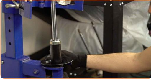
39 Installieren Sie die Feder am Stoßdämpfer.
