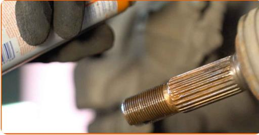
**52** Die Antriebswelle in die Radnabe installieren.
