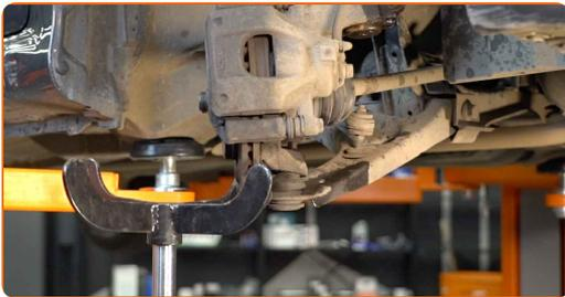
21 Ziehen Sie den unteren Arm vom Achsschenkel ab. Verwenden Sie einen Kugelgelenkabzieher. Benutzen Sie ein Brecheisen.
