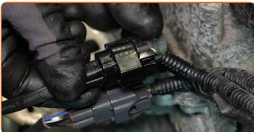
**25** Befestigen Sie die Verkabelung des Sauerstoffsensors mit der Klemme.
