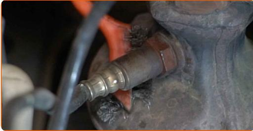
**6** Lösen Sie die Befestigung der Lambdasonde. Verwenden Sie Ring-Gabelschlüssel Nr. 22. Verwenden Sie einen Ratschenschlüssel.
