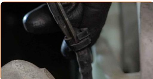
**5** Reinigen Sie die Befestigung der Lambdasonde. Benutzen Sie eine Drahtbürste. Benutzen Sie WD-40-Spray.
