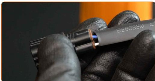
**19** Schrumpfen Sie die Schrumpfschläuche. Verwenden Sie eine Heißluftpistole.
