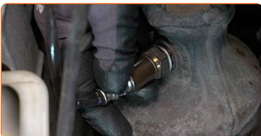
**22** Ziehen Sie die Befestigung der Lambdasonde fest. Verwenden Sie eine 22 mm Lambdasondenstecknuss. Verwenden Sie einen Drehmomentschlüssel. Ziehen Sie ihn mit 40 Nm Drehmoment fest.
