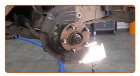
Reinigen Sie die Befestigungselemente, die das Kugelgelenk mit dem Aufhängungslenker verbinden. Benutzen Sie eine Drahtbürste. Benutzen Sie WD-40-Spray.
