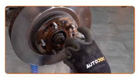
14 Entfernen Sie die Bremsscheibe.
