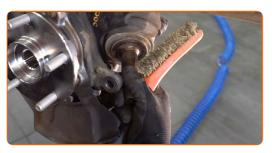
Entfernen Sie den Träger unter dem Achsschenkel.
