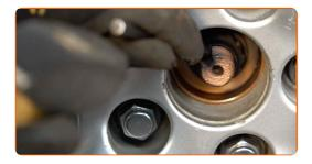
Ziehen Sie die Radschrauben unter Verwendung eines Kreuzmusters an. Verwenden Sie einen Drehmomentschlüssel. Ziehen Sie ihn mit 103 Nm Drehmoment fest.
