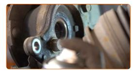
Schrauben Sie die Nabenlagerhalterung ab. Verwenden Sie Stecknuss Nr. 17. Verwenden Sie ein Windeisen.
