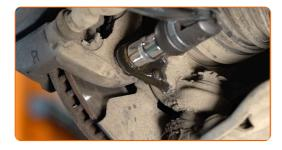
12 Entfernen Sie die Sattelhalterung.
