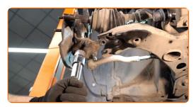
Reinigen Sie die Befestigungen des Radnabenlagers. Benutzen Sie eine Drahtbürste. Benutzen Sie WD-40-Spray.
