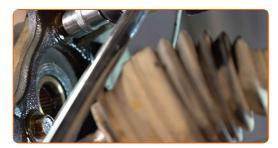
Entfernen Sie die Nabe und das Lager zusammen, da sie eine versiegelte Einheit sind. Benutzen Sie ein Brecheisen. Benutzen Sie einen Hammer.
