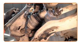
Schrauben Sie die Mutter an die Gelenkwelle. Verwenden Sie Stecknuss Nr. 30. Verwenden Sie ein Windeisen.
