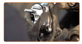
Ziehen Sie die Radnabenlager an. Verwenden Sie Stecknuss Nr. 17. Verwenden Sie einen Ratschenschlüssel.
