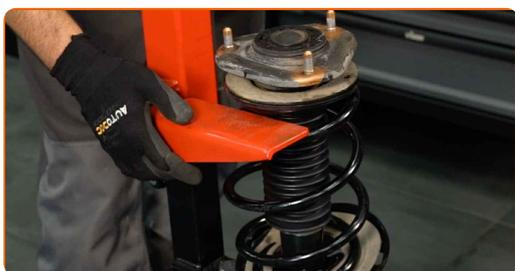
**36** Entfernen Sie das zusammengebaute Federbein.
