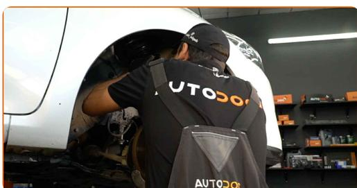
**38** Schrauben Sie die obere Befestigung des Domlagers an. Schrauben Sie diese nicht fest.
