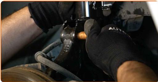
**42** Schrauben Sie das Befestigungselement ein, das das Federbein mit dem Achsschenkel verbindet. Verwenden Sie Ring-Gabelschlüssel Nr. 22. Verwenden Sie Stecknuss Nr. 22.
