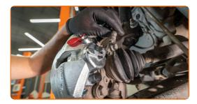
Entfernen Sie die Klammer des Bremsschlauchs.
