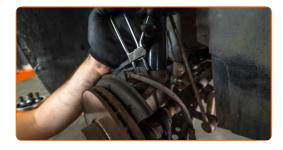
Verbinden Sie die ABS-Sensor Steckdose. Verbinden Sie den Stecker des Verschleißseonsors der Bremsbeläge.
