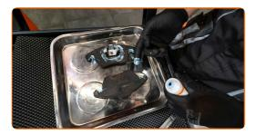
Bauen Sie den Bremssattel zusammen mit den Bremsbelägen ein.
