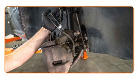
Schrauben Sie den Bremsschlauch vom Bremssattel ab. Verwenden Sie Stecknuss Nr. 11. Verwenden Sie einen Ratschenschlüssel. Bewegen Sie die Bremsschläuche zur Seite. Befestigen Sie die Bremsschläuche mit Hilfe eines Hakens oder eines Stück Drahts an der Karosserie.
