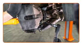
16 Entfernen Sie den Bremssattel.
