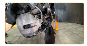
Entfernen Sie die Staubschutzkappen der Bremssattel-Führungsstifte.
