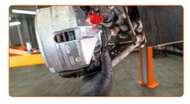
Installieren Sie die Bremssattelfeder.
