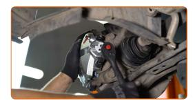
Installieren Sie die Staubschutzkappen der Bremssattel-Führungsstifte.
