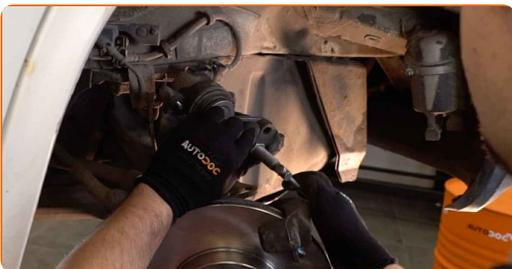
Austausch: Bremsbeläge – VW Transporter T4. Tipp:
