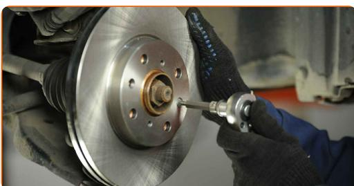
**22** Säubern Sie die Halterung des Bremsstellers. Benutzen Sie eine Drahtbürste. Benutzen Sie einen Bremsenreiniger.
