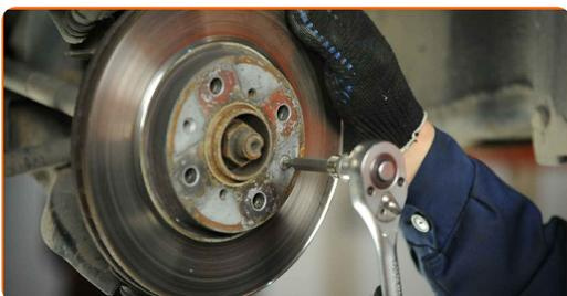
**18** Entfernen Sie die Bremsscheibe.
