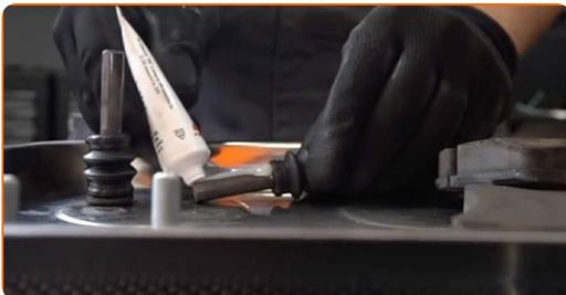
**26** Schrauben Sie die Führungsbolzen hinein.
