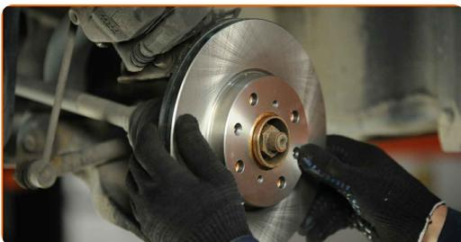
**21** Ziehen Sie die Befestigung der Bremsscheibe fest. Verwenden Sie den Torx T30. Verwenden Sie einen Drehmomentschlüssel. Ziehen Sie ihn mit 9 Nm Drehmoment fest.
