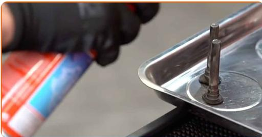
**25** Behandeln Sie die Bremsstapel-Führungstifte. Verwenden Sie das Bremsstapelführungsbolzen-Fett.
