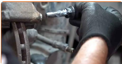
**27** Die Befestigungselemente der Bremssattelhalterung reinigen. Benutzen Sie eine Drahtbürste. Benutzen Sie WD-40-Spray.
