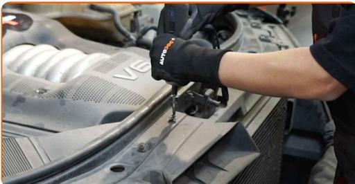
**4** Entferne die Komponenten des Lüftungskanals.
