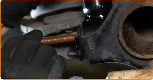
**25** Ziehen Sie den unteren Befestiger des Stoßdämpfers an. Verwenden Sie Ring-Gabelschlüssel Nr. 16. Verwenden Sie Stecknuss Nr. 16. Verwenden Sie einen Drehmomentschlüssel. Ziehen Sie ihn mit 50 Nm Drehmoment fest.+90°
