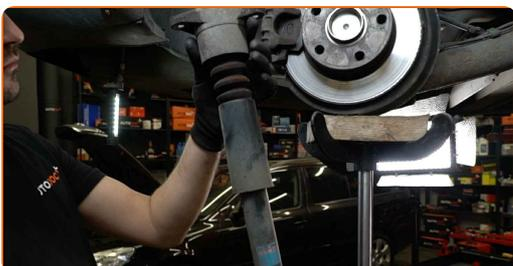
**13** Greifen Sie den Stoßdämpfer mit einem Schraubstock.
