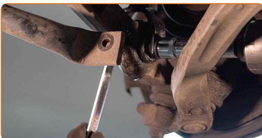
**22** Entfernen Sie die Befestigungsschraube.
