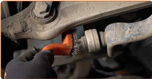
**17** Schrauben Sie das Befestigungselement heraus, das die Druckstange mit dem Stabilisator verbindet. Verwenden Sie Ring-Gabelschlüssel Nr. 16 (2 Teile).
