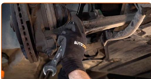
**55** Reinigen Sie die Montagebohrungen und die Gewinde des Querlenkers. Benutzen Sie eine Drahtbürste. Benutzen Sie WD-40-Spray.
