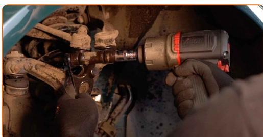
**14** Entfernen Sie die Befestigungsschraube. Verwenden Sie einen Splintentreiber. Benutzen Sie einen Hammer.
