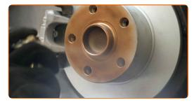
Die Bremsscheibenoberfläche reinigen. Benutzen Sie einen Bremsenreiniger.
