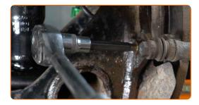
Entfernen Sie die Sattelhalterung.
