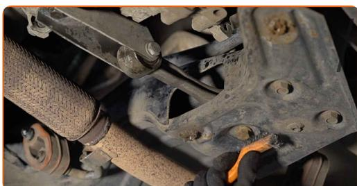
**7** Schrauben Sie das Befestigungselement heraus, das das Motorlager mit dem Getriebegehäuse verbindet. Verwenden Sie Stecknuss Nr. 16. Verwenden Sie einen Ratschenschlüssel.
