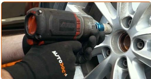
21 Senken Sie das Auto und ziehen Sie die Radschrauben über Kreuz an. Verwenden Sie eine Schlagnuss für Felgen # 17. Verwenden Sie einen Drehmomentschlüssel. Ziehen Sie ihn mit 120 Nm Drehmoment fest.
