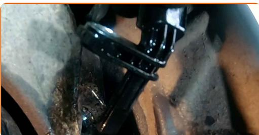
**10** Reinigen Sie den Befestigungssitz des ABS-Sensors. Benutzen Sie eine Drahtbürste. Benutzen Sie WD-40-Spray.
