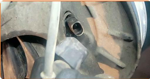
**7** Reinigen Sie die Befestigung des ABS-Sensors. Benutzen Sie eine Drahtbürste. Benutzen Sie WD-40-Spray.
