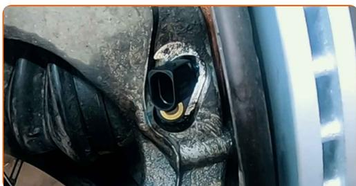
**13** Schrauben Sie die Befestigung, die den ABS-Sensor am Achsschenkel verbindet, fest. Verwenden Sie Inbusschlüssel Nr. H5. Verwenden Sie einen Drehmomentschlüssel. Ziehen Sie ihn mit 7 Nm Drehmoment fest.
