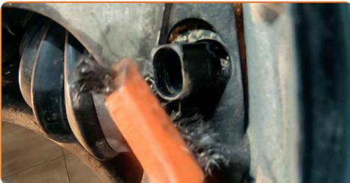
**8** Schrauben Sie die Befestigung des ABS-Sensors ab. Verwenden Sie Inbusschlüssel Nr. H5. Verwenden Sie einen Ratschenschlüssel.
