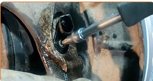
**9** Lösen Sie den ABS-Sensor.
