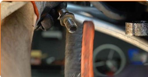
14 Schrauben Sie einen neuen Spurstangenkopf an.
