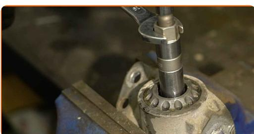
**27** Entfernen Sie die Stoßdämpferhalterung, die Manschette und den Stoßstopp.
