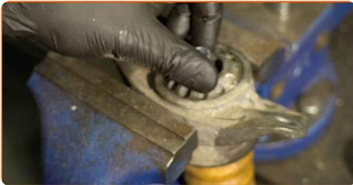
**29** Ziehen Sie die Mutter der Stoßdämpferkolbenstange fest. Verwenden Sie einen Stoßdämpfer Steckschlüsseleinsatz DDN#8. Verwenden Sie Stecknuss Nr. 16. Verwenden Sie einen Drehmomentschlüssel. Ziehen Sie ihn mit 25 Nm Drehmoment fest.
