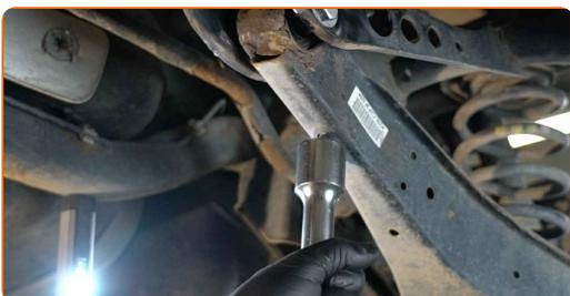
**15** Entfernen Sie die Befestigungsschraube. Verwenden Sie Ring-Gabelschlüssel Nr. 18. Benutzen Sie ein Brecheisen.
