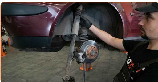
**12** Entfernen Sie die Schutzkappe der Stoßdämpferhalterung.
