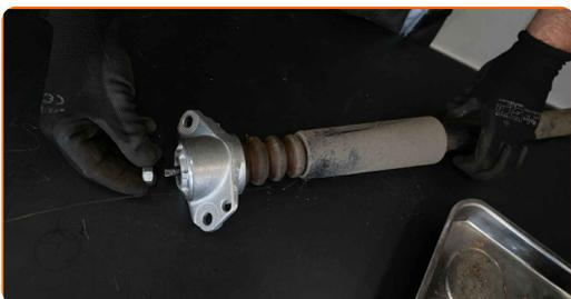
**18** Ziehen Sie die Befestigungsschrauben des Stoßdämpfers fest. Verwenden Sie Ring-Gabelschlüssel Nr. 16. Benutzen Sie einen Rollgabelschlüssel. Verwenden Sie einen Drehmomentschlüssel. Ziehen Sie ihn mit 25 Nm Drehmoment fest.
