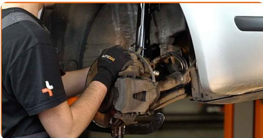
**46** Stützen Sie die Achsschenkel auf. Benutzen Sie einen hydraulischen Getriebeheber.
