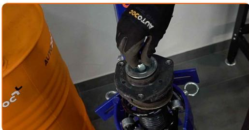
**39** Ziehen Sie die Federbeinkolbenstangenmutter an. Verwenden Sie Ring-Gabelschlüssel Nr. 21. Verwenden Sie Inbusschlüssel Nr. H7. Verwenden Sie einen Drehmomentschlüssel. Ziehen Sie ihn mit 60 Nm Drehmoment fest.
