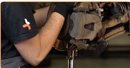
**47** Die Keilwellen des CV-Gelenks der Antriebswelle reinigen. Benutzen Sie WD-40-Spray.
