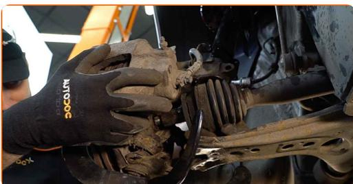
**49** Entfernen Sie den Träger unter dem Achsschenkel.
