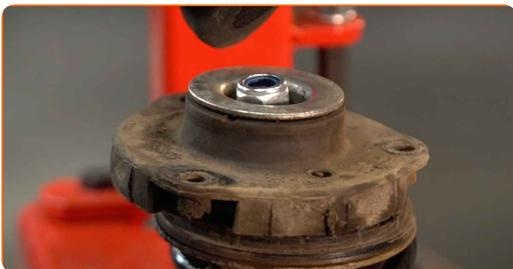
**38** Ziehen Sie die Federbeinkolbenstangenmutter an. Verwenden Sie Stecknuss Nr. 21. Verwenden Sie Inbusschlüssel Nr. H6. Verwenden Sie einen Drehmomentschlüssel. Ziehen Sie ihn mit 60 Nm Drehmoment fest.
