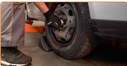
**7** Lösen Sie die Radhalterungsschrauben. Verwenden Sie eine Schlagnuss für Felgen # 17.
