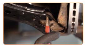
Ziehen Sie die Befestigungen des Kugelgelenks an. Verwenden Sie Stecknuss Nr. 13. Verwenden Sie einen Drehmomentschlüssel. Ziehen Sie ihn mit 20 Nm Drehmoment fest.+90°
