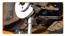
Ziehen Sie das vordere Befestigungselement an, das den Querlenker mit dem Hilfsrahmen verbindet. Verwenden Sie Stecknuss Nr. 18. Verwenden Sie einen Drehmomentschlüssel. Ziehen Sie ihn mit 70 Nm Drehmoment fest.+90°
