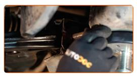
Schrauben Sie die vordere Armbefestigung an. Verwenden Sie Ring-Gabelschlüssel Nr. 18.
