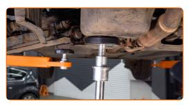
Entfernen Sie die Befestigungsschraube. Benutzen Sie ein Brecheisen. Verwenden Sie einen Gummi-Hammer.
