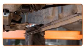
Entfernen Sie den Arm. Benutzen Sie ein Brecheisen.
