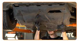
Schrauben Sie die Verbindungselemente der Schalleindrucksdämmung ein. Verwenden Sie Stecknuss Nr. 12. Verwenden Sie einen Kreuzschlitzschraubendreher.
