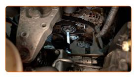
Entfernen Sie den Keilrippenriemen.
