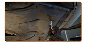
12 Entfernen Sie die Kotflügel-Abdeckung.
