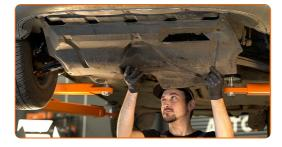
Schrauben Sie die Verbindungselemente der Schalleindrucksdämmung ein. Verwenden Sie Stecknuss Nr. 12. Verwenden Sie einen Kreuzschlitzschraubendreher.
