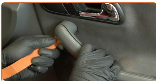
**3** Entfernen Sie die Schrauben der Türarmlehne. Verwenden Sie einen Kreuzschlitzschraubendreher.
