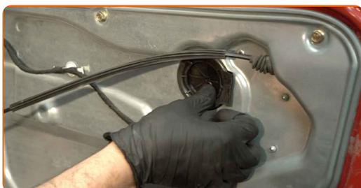
**51** Schließen Sie den Steckverbinder des Spiegelverstellers an der Steuereinheit wieder an.
