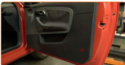
**2** Entfernen Sie die Verkleidung der Türarmlehne. Verwenden Sie einen Zierleistenkeil.
