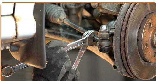
**16** Ziehen Sie die Befestigungsmutter an, die den Spurstangenkopf mit dem Achsschenkel verbindet. Verwenden Sie Stecknuss Nr. 19. Verwenden Sie einen Drehmomentschlüssel. Ziehen Sie ihn mit 20 Nm Drehmoment fest.+90°
