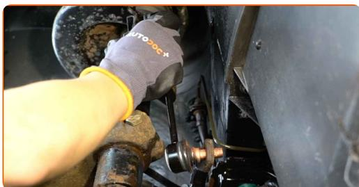
**12** Schrauben Sie die Befestigungen der Koppelstange ein. Verwenden Sie Ring-Gabelschlüssel Nr. 16. Verwenden Sie Stecknuss Nr. 19. Verwenden Sie einen Ratschenschlüssel.
