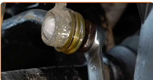
**8** Schrauben Sie das Befestigungselement heraus, das die Druckstange mit dem Federbein verbindet. Verwenden Sie Ring-Gabelschlüssel Nr. 16. Verwenden Sie Stecknuss Nr. 19. Verwenden Sie einen Ratschenschlüssel.
