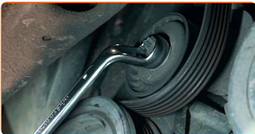
**9** Entfernen Sie den Keilrippenriemen.
