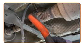
Lösen Sie die Befestigung der Lambdasonde. Verwenden Sie Ring-Gabelschlüssel Nr. 22.
