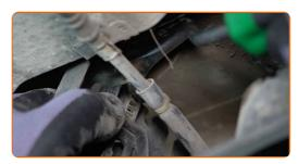
Trennen Sie den Stecker der Lambdasonde. Verwenden Sie einen Lösehebel, um die Clips zu entfernen.
