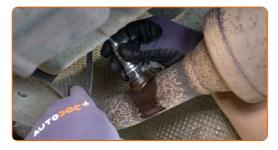
Ziehen Sie die Befestigung der Lambdasonde fest. Verwenden Sie Ring-Gabelschlüssel Nr. 22. Verwenden Sie einen Drehmomentschlüssel. Ziehen Sie ihn mit 37 Nm Drehmoment fest.
