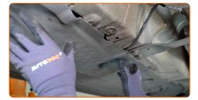
Ziehen Sie die Befestigungen der unteren Ölwannen-Abdeckung fest. Verwenden Sie Stecknuss Nr. 10. Verwenden Sie einen Ratschenschlüssel.
