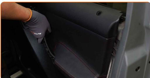
**63** Schrauben Sie die Befestigungen der Türinnenverkleidung ein. Verwenden Sie einen Kreuzschlitzschraubendreher.
