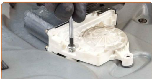
**27** Entfernen Sie den Motor des elektrischen Fensterhebers.
