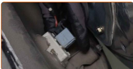
**60** Stecken Sie den Stecker des Fensterheberschaltermoduls ein.
