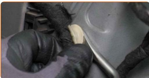
**19** Entfernen Sie die Abdeckungen der Türverkleidung. Verwenden Sie einen Zierleistenkeil.
