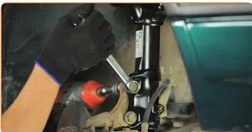
**11** Entfernen Sie die Befestigungsschrauben (2 Stück).
