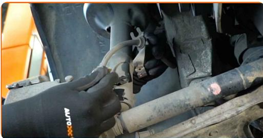
**9** Die Befestigungselemente, die das Federbein mit dem Achsschenkel verbinden, reinigen. Benutzen Sie eine Drahtbürste. Benutzen Sie WD-40-Spray.
