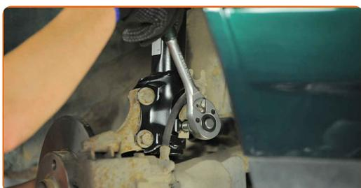
**8** Entfernen Sie die Halterung der Stoßdämpferstrebe.
