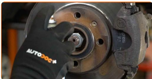
**47** Die Bremsscheibenoberfläche reinigen. Benutzen Sie einen Bremsenreiniger.
