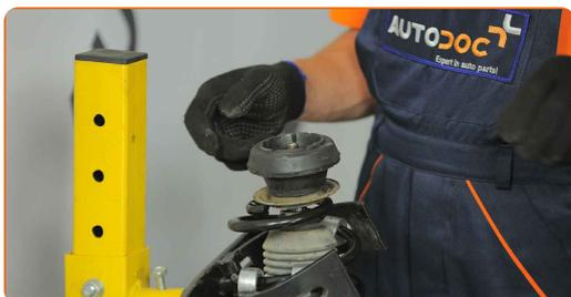
**30** Ziehen Sie die Federbeinkolbenstangenmutter an. Verwenden Sie Stecknuss Nr. 21. Verwenden Sie einen Drehmomentschlüssel. Ziehen Sie ihn mit 65 Nm Drehmoment fest.
