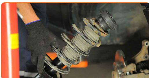
**18** Stellen Sie das Dämpferbein auf das Federspannwerkzeug.
