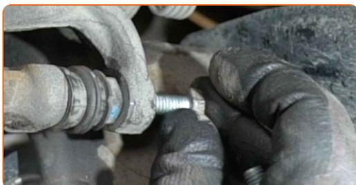
**35** Ziehen Sie die Bremssattelbefestigungen fest. Verwenden Sie Stecknuss Nr. 13. Verwenden Sie einen Drehmomentschlüssel. Ziehen Sie ihn mit 35 Nm Drehmoment fest.
