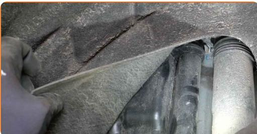
**12** Reinigen Sie die Befestigung des Aktivkohlebehälters. Benutzen Sie eine Drahtbürste. Benutzen Sie WD-40-Spray.
