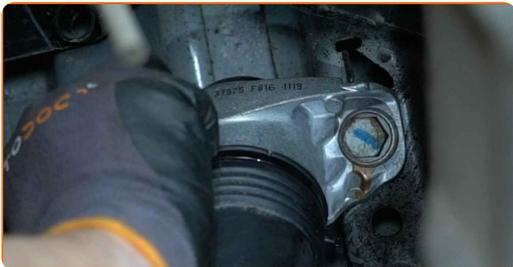
**36** Ziehen Sie die Befestigungen des Stoßdämpferlagers an. Verwenden Sie Stecknuss Nr. 16. Verwenden Sie einen Drehmomentschlüssel. Ziehen Sie ihn mit 50 Nm Drehmoment fest.+45°
