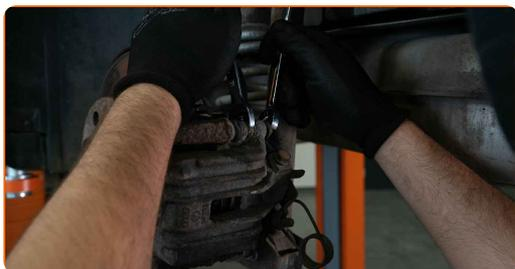
**11** Entfernen Sie den Bremssattel.
