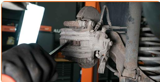
**9** Die Bremssattelbefestigungen reinigen. Benutzen Sie eine Drahtbürste. Benutzen Sie einen Bremsenreiniger.
