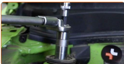
**52** Behandeln Sie die Befestigungselemente des Federbeinstützlagers. Benutzen Sie ein Kupferschmiermittel.
