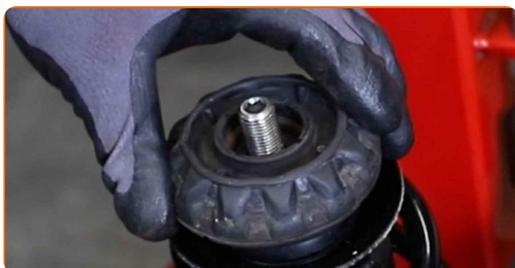
**31** Ziehen Sie die Federbeinkolbenstangenmutter an. Verwenden Sie Inbusschlüssel Nr. H7. Verwenden Sie eine 21 mm Schienenmutterstecknuss. Verwenden Sie einen Drehmomentschlüssel. Ziehen Sie ihn mit 60 Nm Drehmoment fest.
