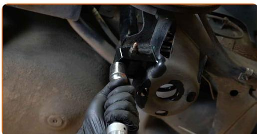
**33** Ziehen Sie den unteren Befestiger des Stoßdämpfers an. Verwenden Sie Stecknuss Nr. 16. Verwenden Sie einen Drehmomentschlüssel. Ziehen Sie ihn mit 40 Nm Drehmoment fest.+90°
