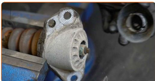
**17** Reinigen Sie die Befestigungen vom Stoßdämpferschaft. Benutzen Sie eine Drahtbürste. Benutzen Sie WD-40-Spray.
