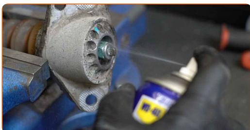
**18** Entfernen Sie die Befestigung der Stoßdämpferkolbenstange. Verwenden Sie einen Stoßdämpfer Steckschlüsseleinsatz DDN#6. Verwenden Sie Stecknuss Nr. 16. Verwenden Sie einen Ratschenschlüssel.
