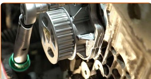
**62** Schrauben Sie die Befestigungen der Wasserpumpe fest. Verwenden Sie Inbusschlüssel Nr. H6. Verwenden Sie einen Drehmomentschlüssel. Ziehen Sie ihn mit 20 Nm Drehmoment fest.
