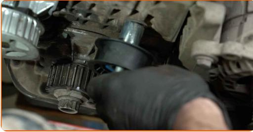
**69** Schrauben Sie die Befestigung der Umlenkriemenscheibe des Zahnriemens fest. Verwenden Sie Stecknuss Nr. 15. Verwenden Sie einen Drehmomentschlüssel. Ziehen Sie ihn mit 25 Nm Drehmoment fest.
