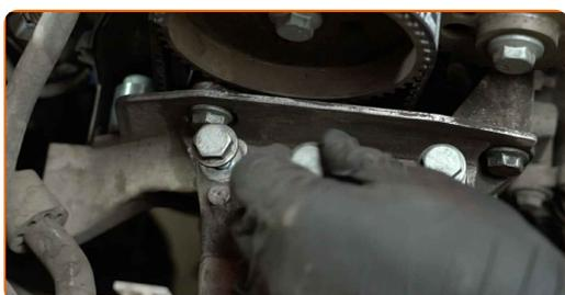
**87** Ziehen Sie das obere Befestigungselement des Motorlagers an. Verwenden Sie Stecknuss Nr. 16. Verwenden Sie einen Drehmomentschlüssel. Ziehen Sie ihn mit 50 Nm Drehmoment fest.
