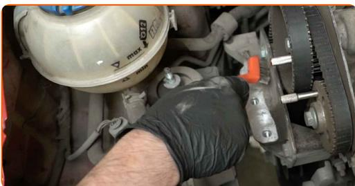
**35** Schrauben Sie die Befestigungen der Motoraufhängung heraus. Verwenden Sie Stecknuss Nr. 16. Verwenden Sie einen Ratschenschlüssel.
