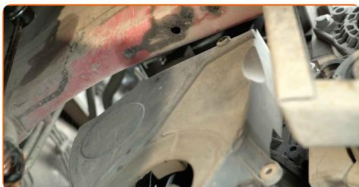
**27** Drehen Sie das Kurbelwellenrad. Verwenden Sie die 12-Kant-Stecknuss Nr. 21. Verwenden Sie einen Ratschenschlüssel.
