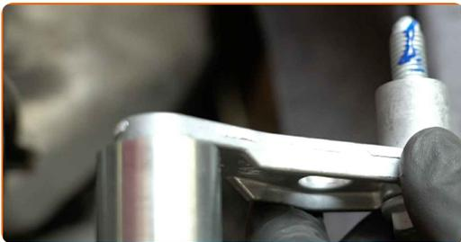
**71** Bauen Sie die Halterung der Umlenkriemenscheibe des Zahnriemens mitsamt integrierter Rolle ein.
