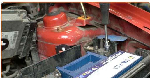
**5** Entfernen Sie die Batterieklemmen.
