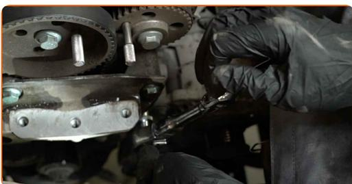
**36** Entfernen Sie die Befestigungsschrauben.
