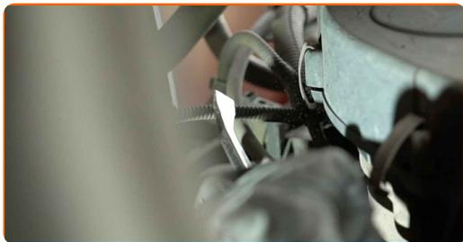
**26** Entfernen Sie die untere Zahnriemenabdeckung.
