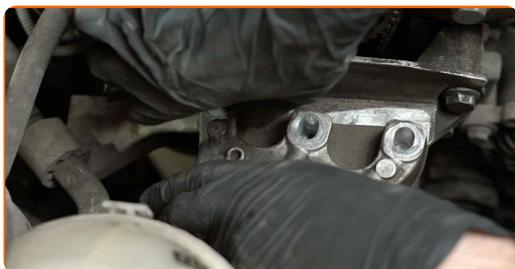
**86** Schrauben Sie die oberen Befestigungen des Motorlagers ein. Verwenden Sie Stecknuss Nr. 16. Verwenden Sie einen Ratschenschlüssel.
