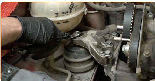
**33** Entfernen Sie die Befestigungsschrauben.
