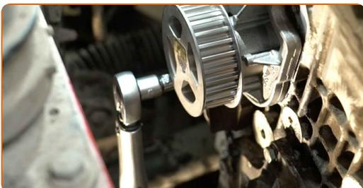
**63** Schrauben Sie die Befestigungen der seitlichen Zahnriemenabdeckung ein. Verwenden Sie Stecknuss Nr. 10. Verwenden Sie einen Ratschenschlüssel.
