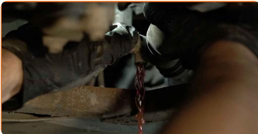
**15** Lassen Sie das Kühlmittel aus dem Motor ab.
