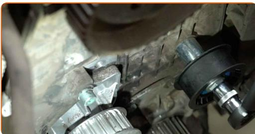
**70** Behandeln Sie die Befestigungsschraube. Verwenden Sie ein Dichtmittel.
