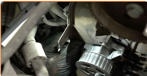
**61** Schrauben Sie die Befestigungen der Wasserpumpe ein. Verwenden Sie Inbusschlüssel Nr. H6. Verwenden Sie einen Ratschenschlüssel.
