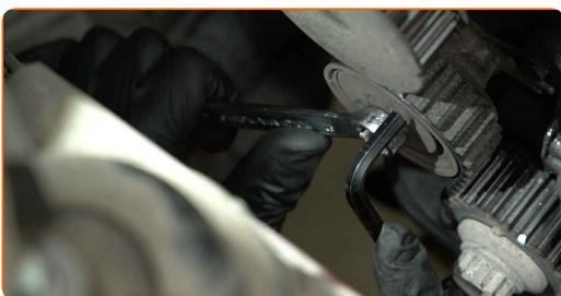
**42** Entfernen Sie die Spannrolle des Zahnriemens.
