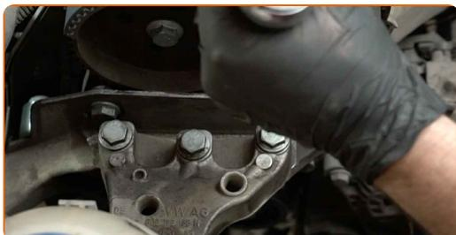
**88** Entfernen Sie den Träger unter dem Motor.
